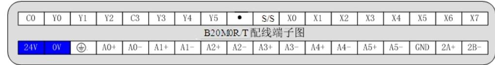
注: 对空端子 请勿接线, 本机上的接地端子 务必正确的接地, 可提高本产品的抗干扰能力, 但不要和强电系统共地。
