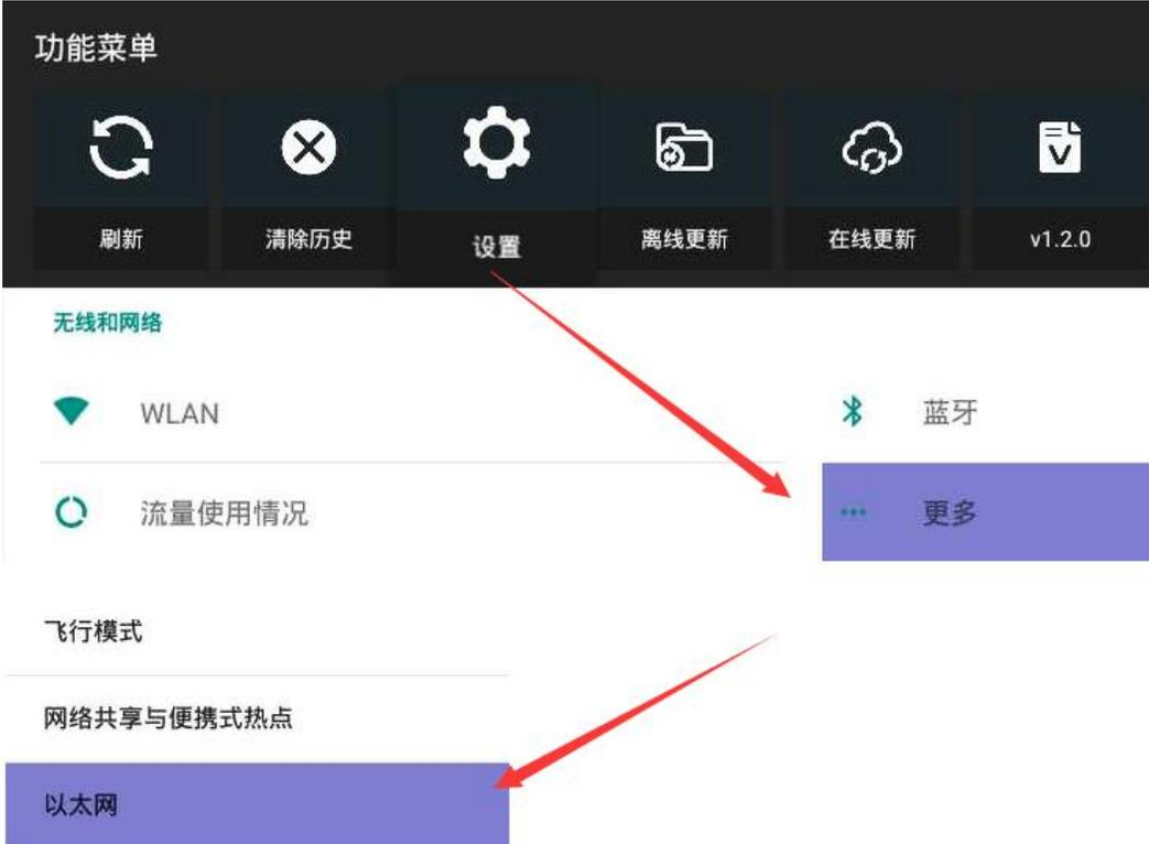
进入以太网连接界面，选择【开启】，遥控器按下【OK】键，打开以太网连接，点击【以太网模式】，可选择“动态获取”或者“静态地址”，进入 IP 设置界面，配置好相关信息选择【连接】，遥控器按下【OK】键即可。
